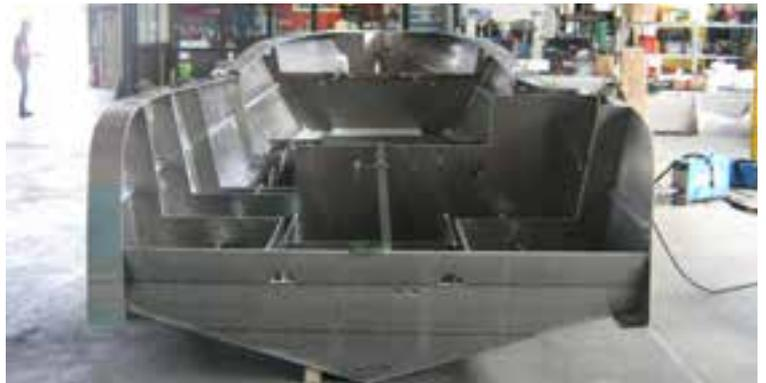
**Der Rumpf wird in einem hochmodernem Schweißverfahren mit dem Doppel-Bogen-Pulse Schweißgerät "Weco-Power-Pulse" gefertigt.**
